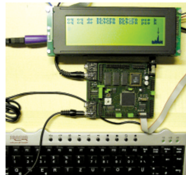
Bild 6: Test der DSP-Baugruppe für PSK31-Betrieb
